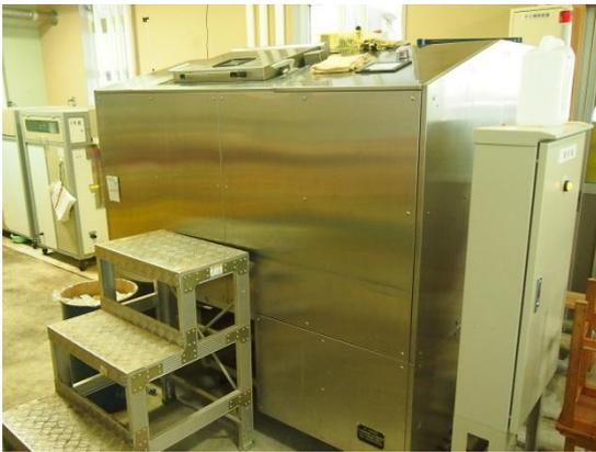
生ごみ処理の心臓部はこの機械。粉碎、分解、発酵、ペレット化を一台でこなしている
